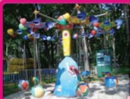
Целочная карусель «Космос» Для детей до 15 лет и весом не более 50кг Кол-во посадочных мест – 8 Размах во время движения – 9 м Высота – 4,5 м Потребляемая мощность – 1,5 кВт
