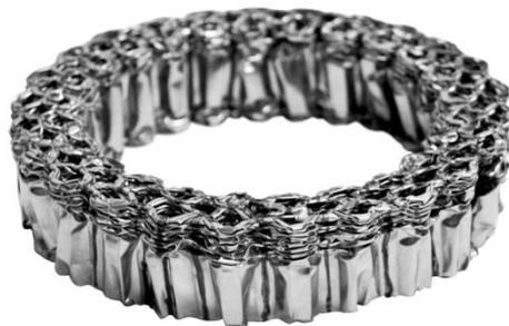
Рис. 6.10 Фрагмент сотового амортизатора после обжатия.
