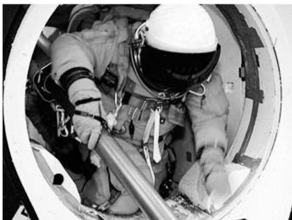
Рис. 2.20. Космонавт в аварийно-спасательном скафандре отрабатывает аварийное покидание ВКС «Шаттл» через боковой люк.[25].
