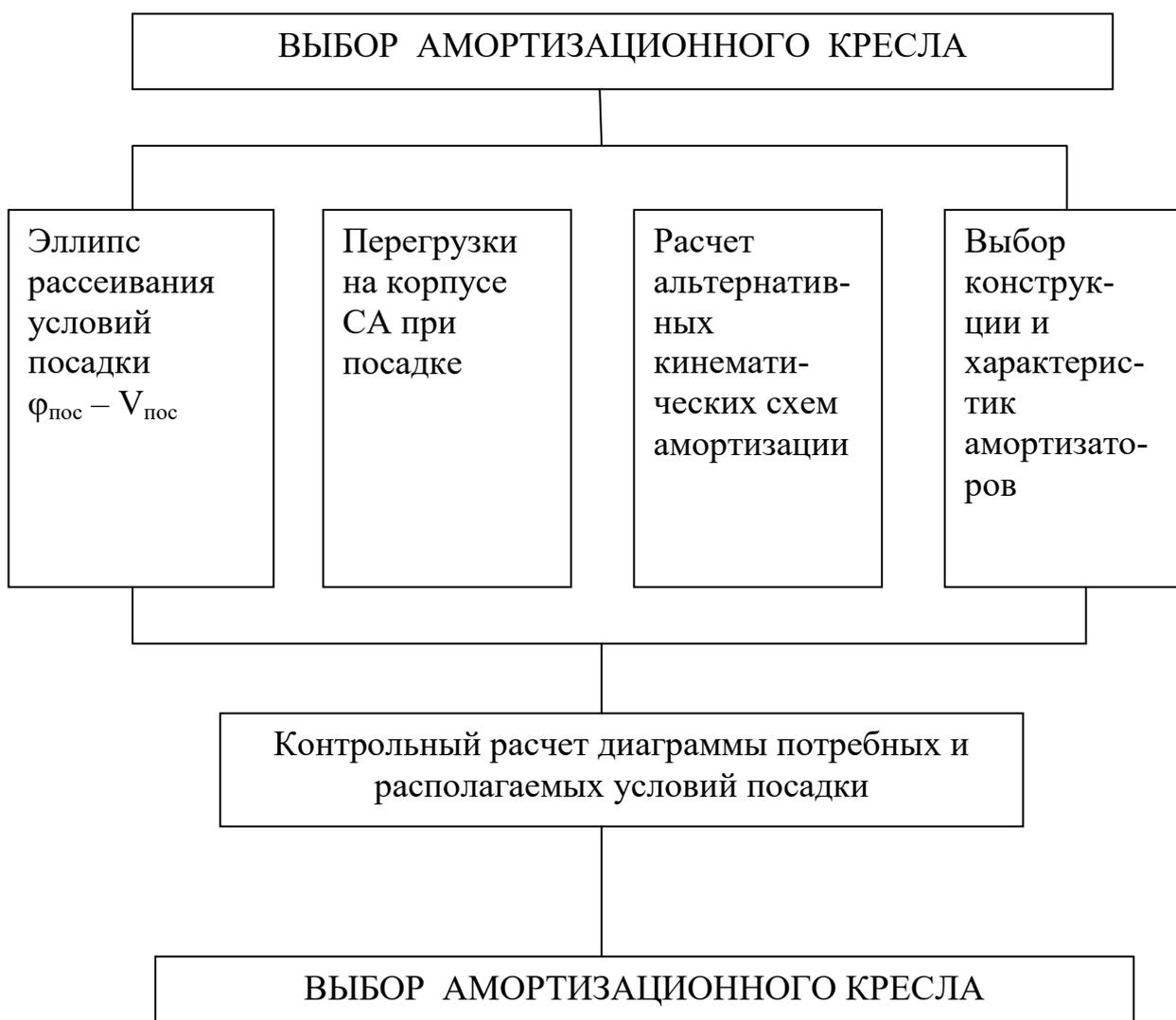
Рис. 6.16. Структура работ по выбору оптимального амортизационного кресла СА.
