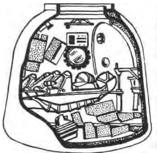
Рис. 2.10. Кресло космонавта корабля «Союз» и схема размещения кресел в СА; на схеме кресла показаны в нижнем положении [63; 117].
