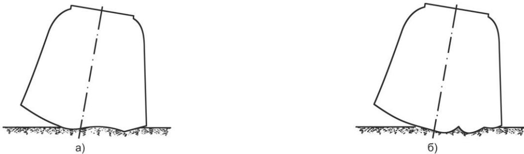
Рис. 4.14. Схемы удара СА с деформируемым корпусом об упруго – пластический грунт; а) сохранение плавного контура днища; б) «затекание» грунта в полости деформированного днища.
