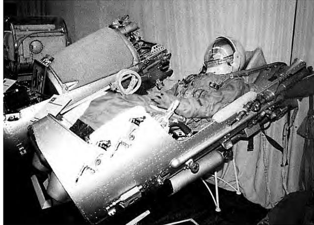
Рис. 2.2. Кресло космонавта корабля «Восток». На заднем плане - его прототип с гермоконтainerом животных (ГКЖ). [74]
