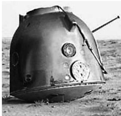
Рис. 2.19. Спускаемый аппарат корабля «Шень Чжоу», внешний вид после посадки и отстрела парашютной системы [24;173].
